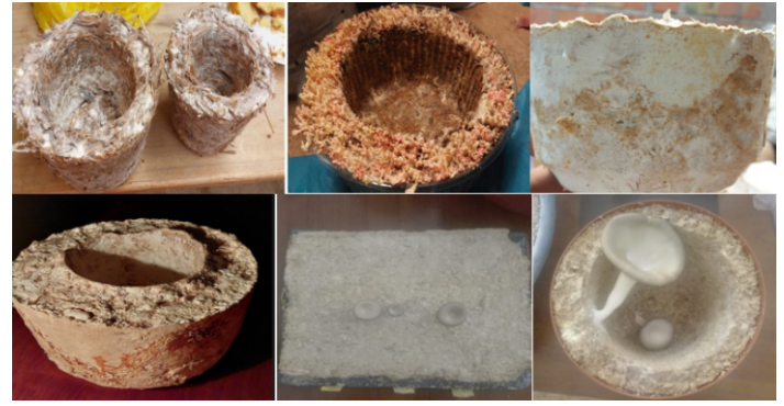
Figura 8: Desmolde y corrida del blanco del hongo en la superficie externa de los micomateriales.
