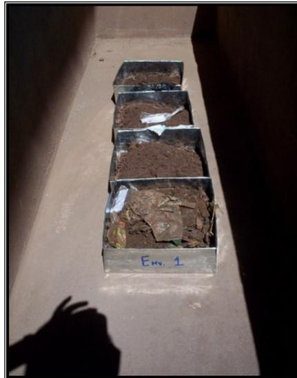
*Nota.* Se ha realizado un primer sacado en espacio abierto de las muestras extraídas del Relleno de RSU y luego se ha llevado al horno para el secado final y determinar el contenido de humedad del Relleno de RSU del Botadero de San Antonio de Cusco.
