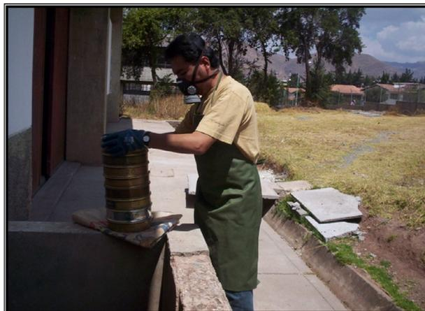
*Nota.* Con el Material Inorgánico (suelo) se ha desarrollado el ensayo granulométrico convencional de Mecánica de Suelos, material resultado del depósito de demoliciones de viviendas, el mismo que ha sido utilizado para la cobertura del Relleno de RSU del Botadero de San Antonio de Cusco.
