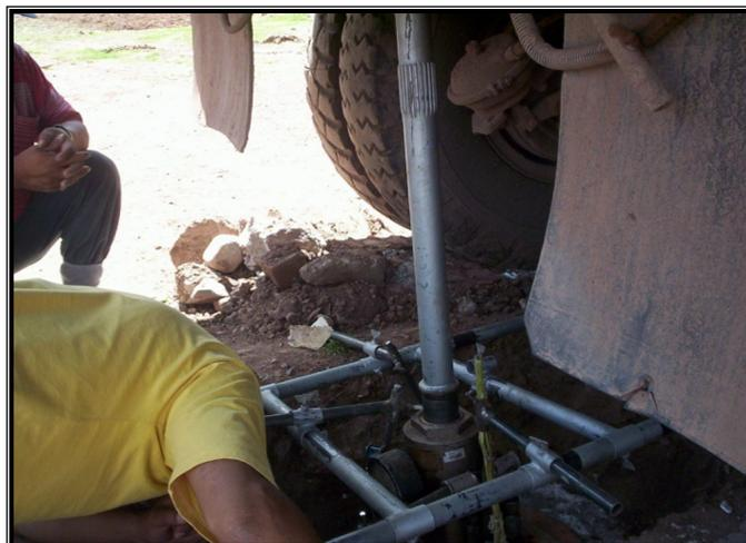
*Nota.* Ensayo de Carga en Placa, con la finalidad de determinar la deformación (asentamiento) del relleno del Botadero de San Antonio de Cusco.
